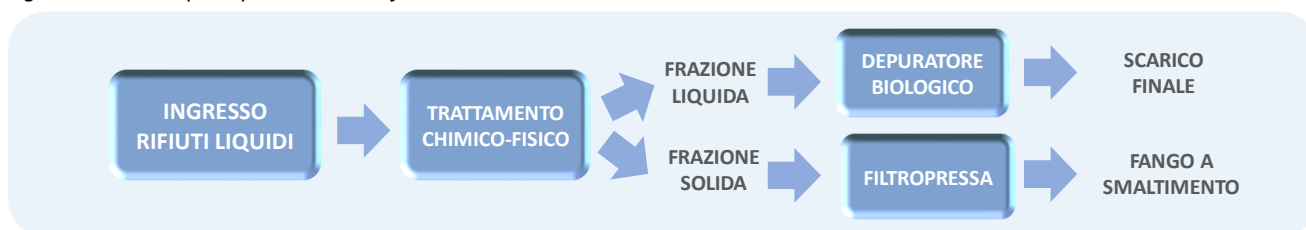
Figura 1 Schema tipo impianto chimico-fisico
