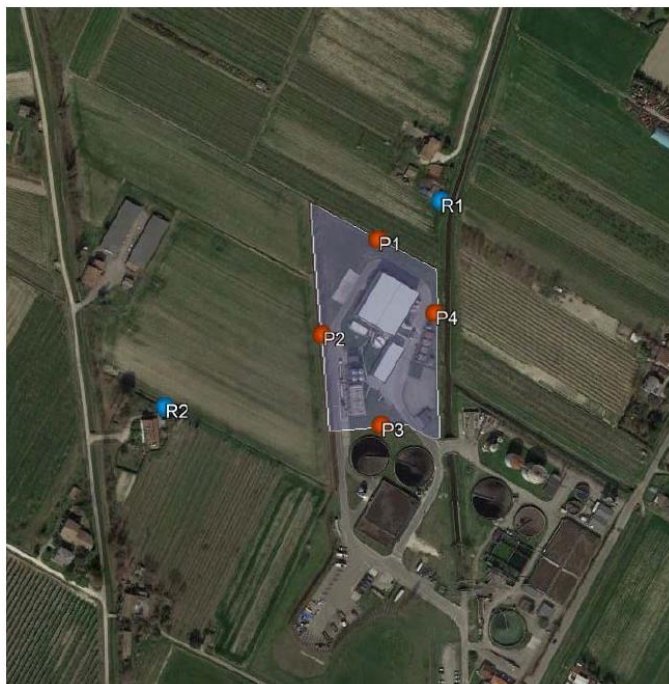
Figura 19 Planimetria dei punti di rilievo fonometrico
