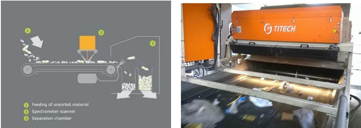
Figura 8 Schema e particolare della selezione automatica tramite lettore ottico
