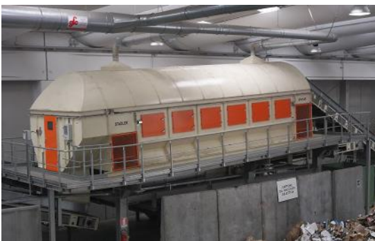
Figura 7 Particolare del vaglio rotante e del deferrizzatore
