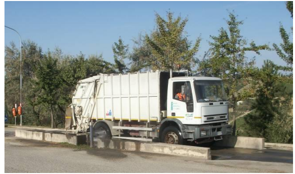
Figura 16 Impianto di lavaggio ruote
