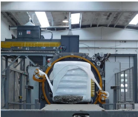
Figura 11 Particolare della pressa imballatrice con annessa filmatrice e delle balle filmate prodotte
