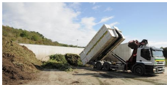
Figura 13 Conferimento rifiuto ligneo-cellulosico
