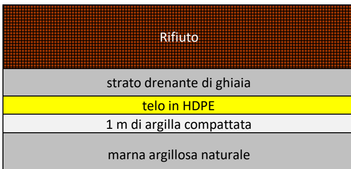
Figura 44 Struttura del fondo della discarica
